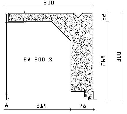
Serienmäßig haben alle Rolladenkästen der Typenreihe EV eine spezielle Clip - Innenschiene für den einfachen, schraublosen EASY - CLIP - Deckelanschluss, mit 15 mm Ausladung, sowie ein U-Profil als unterem Abschluss an der Außenschürze.
